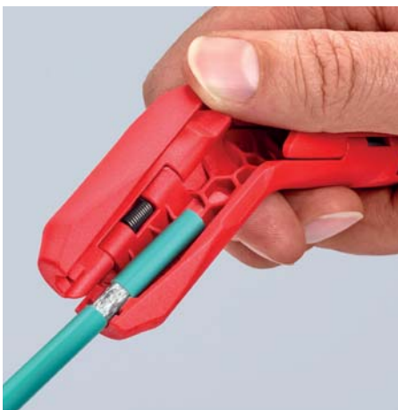
Dégainage d'un câble de données
