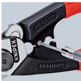
Sertissage de l'embout sur le câble tracteur
