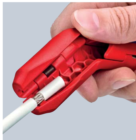
Dégainage d'un câble coaxial
