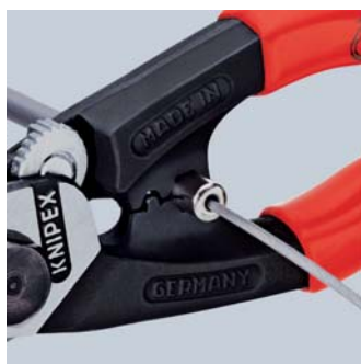
Sertissage des embouts sur les gaines Bowden
