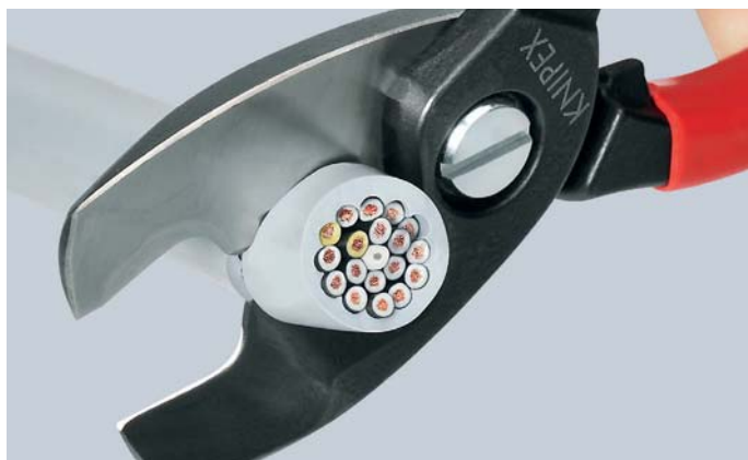
Coupe définitive: une fois la gaine du câble coupée dans le profil avant, on coupe les conducteurs dans le profil arrière. Coupe préliminaire à l'avant, coupe définitive à l'arrière – la coupe est plus facile.
