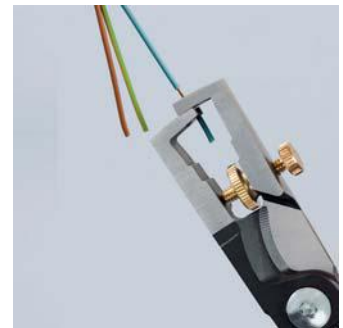
Repères de longueur : Repères visuels aidant au dénudage répété de longueurs usuelles (11 et 16 mm)
