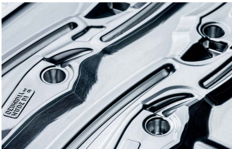
Matrices de forge pour la pince coupante à axe intégré et forgé en une seule pièce.
