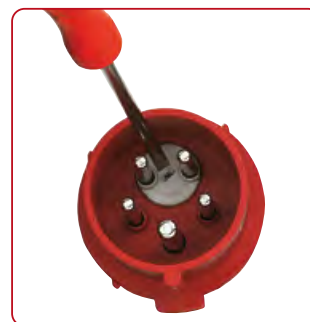
L'inversion de phases se fait par pression du tournevis et par rotation des 2 phases à inverser
