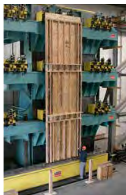
Test d'un immeuble de trois étages à l'échelle 1. Laboratoire Simpson Strong-Tie - T.GILB Stockton
