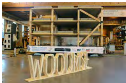
Essai sismique lors de Woodrise 2017
