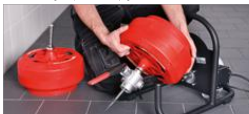
Tambour interchangeable pour différentes plages de travail
