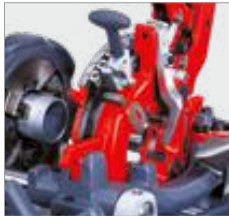
Tête filière automatique avec alimentation en huile automatique
