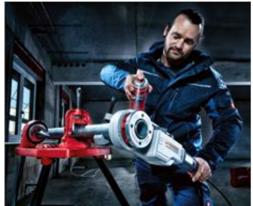
Réalisation de filetages avec bétabli tripode universel
