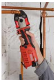
Mâchoires série Compact pour tubes en cuivre, acier, acier inoxydable, PEX et multicouches. Voir page 10.7
