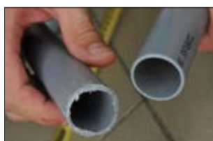
Coupe avec une scie (à gauche) et avec le P-TEC 3240 (à droite).
