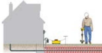
Connexion directe aux lignes de distribution.
