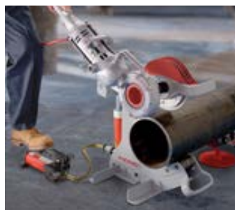
Coupe-tubes modèle 258 utilisant le moteur 700 Power Drive pour la coupe
