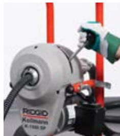
Engagez l'embrayage pour faire tourner le flexible
