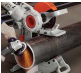
Modèle 258 avec rouleau pour chanfreinage. Cette opération nécessite deux opérateurs
