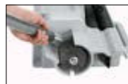
Le disque à ébavurer en option permet de poncer le diamètre extérieur pour obtenir des raccords nets
